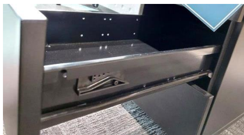
rys. 2- metalowy korpus szuflady z prowadnicami
