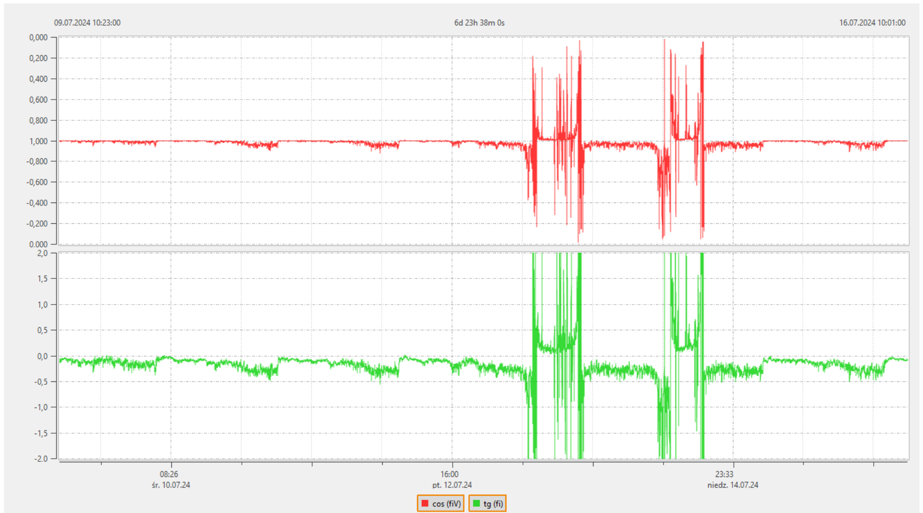
Rysunek 4.4. Wykres zmienności wartości współczynnika mocy \cos \varphi oraz współczynnika \tan \varphi dla punktu RG2Z1.
