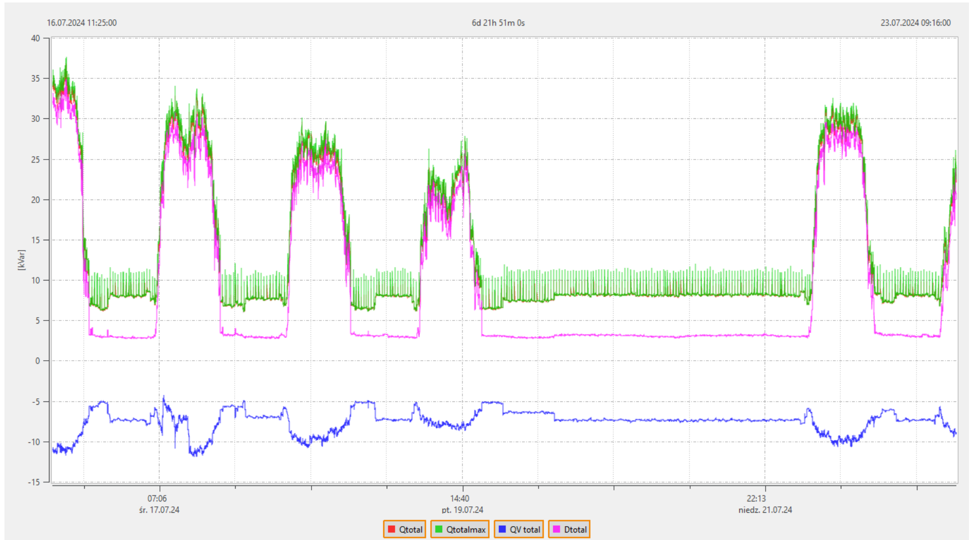
Rysunek 7.3. Wykres zmienności wartości mocy biernej całkowitej, wartości szczytowej biernej całkowitej, składowej biernej częstotliwości 50 Hz (QV total), odkształcenia (Dtotal) dla punktu RG3Z2.
