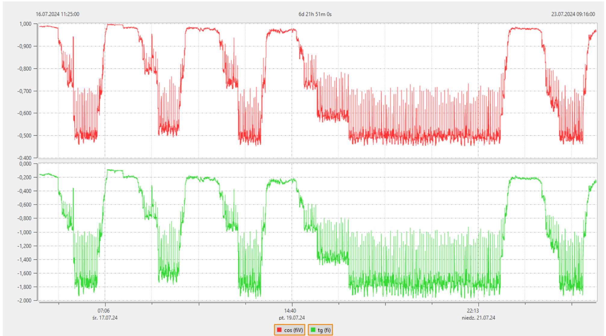
Rysunek 7.4. Wykres zmienności wartości współczynnika mocy \cos \varphi oraz współczynnika \tan \varphi dla punktu RG3Z2.
