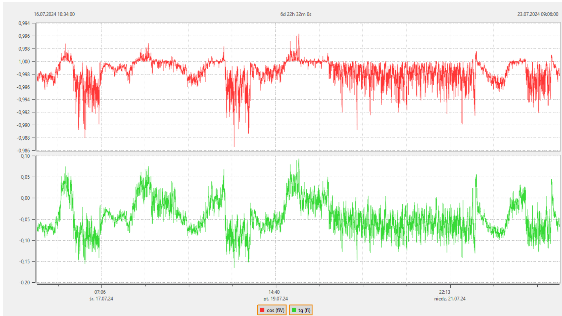
Rysunek 2.4. Wykres zmienności wartości współczynnika mocy \cos \varphi oraz współczynnika \tan \varphi dla punktu RG1Z1
