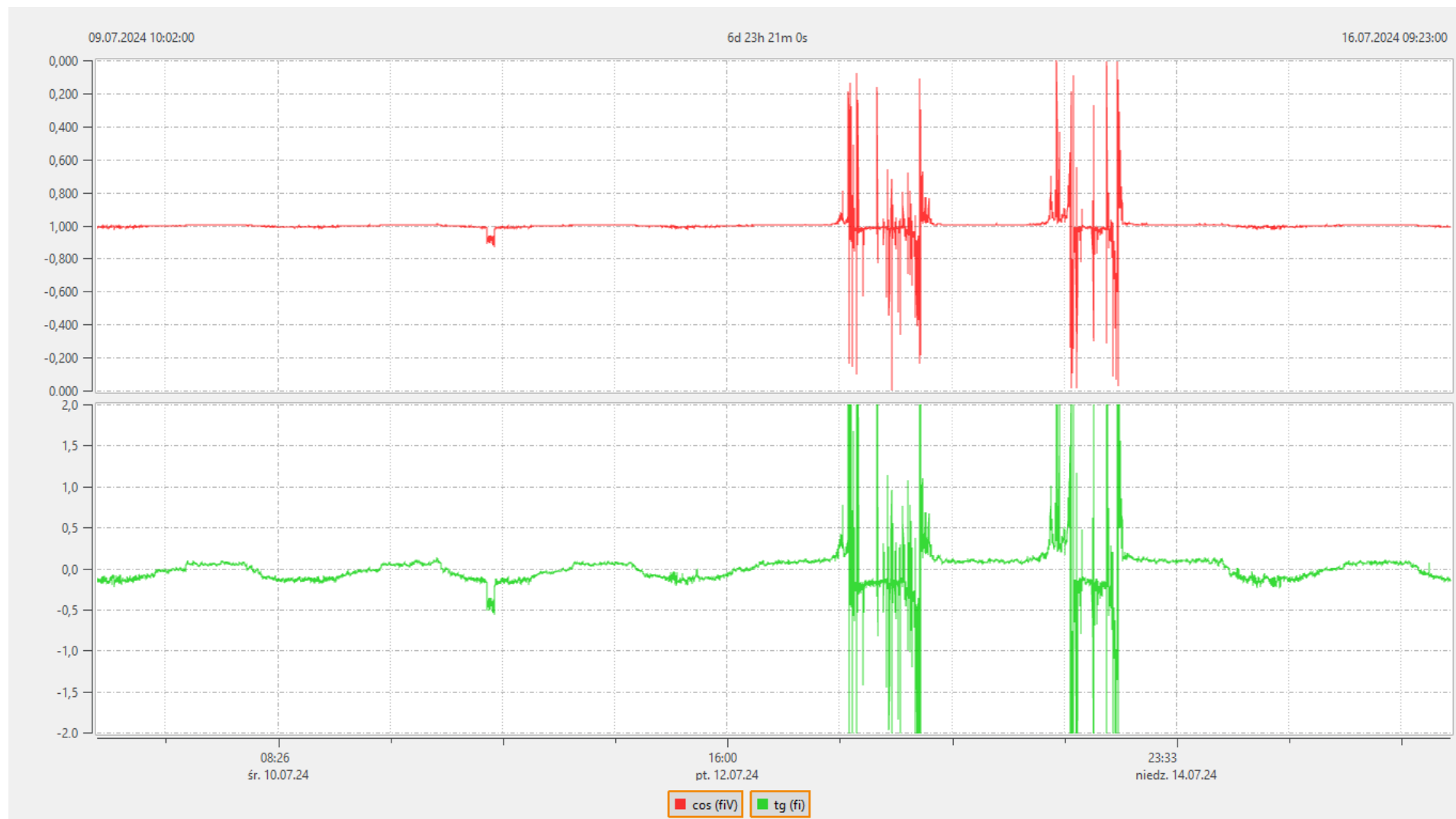
Rysunek 3.4. Wykres zmienności wartości współczynnika mocy \cos \varphi oraz współczynnika \tan \varphi dla punktu RG1Z2.
