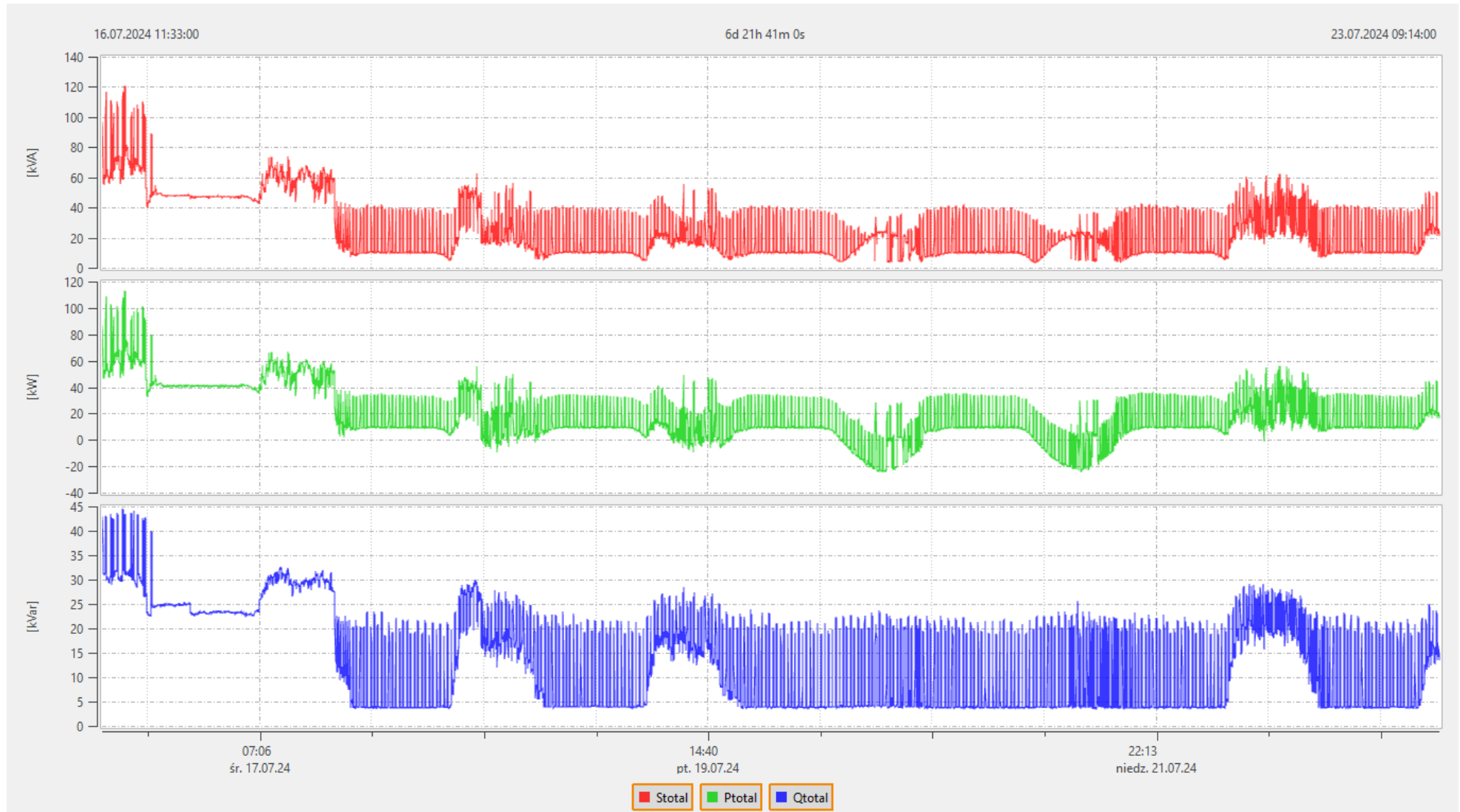
Rysunek 6.1. Wykres zmienności wartości mocy pozornej całkowitej ( S_{total} ), czynnej całkowitej ( P_{total} ) i biernej całkowitej ( Q_{total} ) dla punktu RG3Z1.
